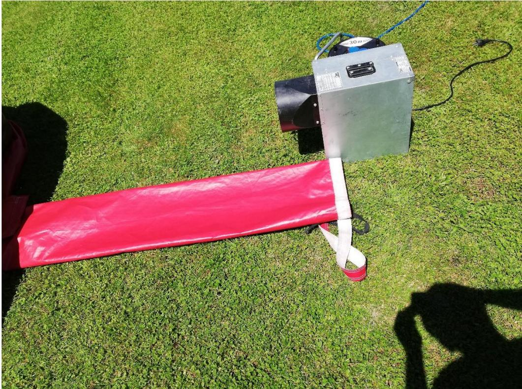
*Schlauch am Gebläse mit Klettverschluss befestigen
